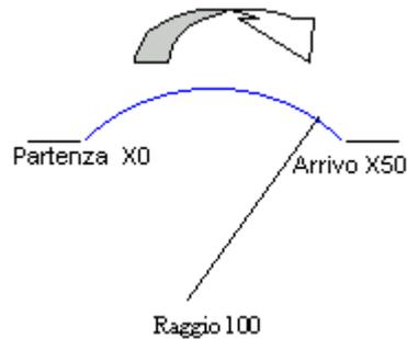
Notate che i parametri di interpolazione sono stati inseriti in modo incrementale e con il giusto segno, secondo gli assi cartesiani, **J** dunque va dichiarato con segno negativo.
