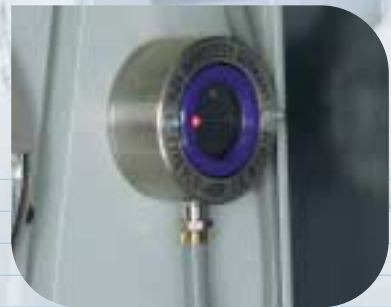
Ricevitore per tastatore a raggi infrarossi
