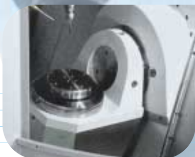
Tavola tilting con dispositivo di bloccaggio palette Erowa ITS Ø 148
