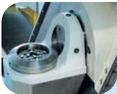
Tavola tilting con dispositivo di bloccaggio palette 3R Macro Magnum Ø 156 mm
