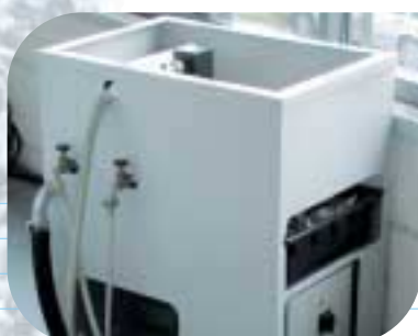
Filtraggio del lubrorefrigerante (piccolo) senza adduzione interna del refrigerante
