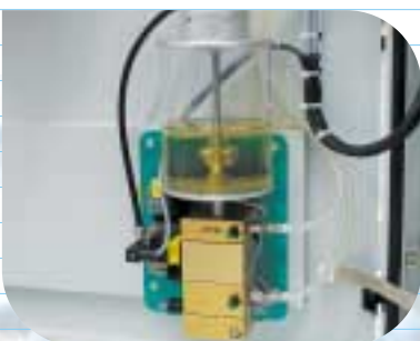
Lubrificazione a quantità minima dosabile mediante il programma
