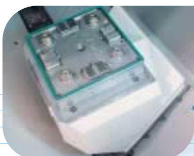
Tavola con dispositivo di bloccaggio integrato del tipo 3R Dynafix
