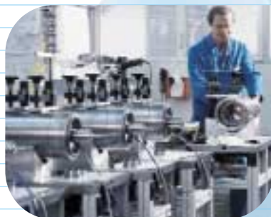
Perfettamente pulito e preciso: montaggio mandrino flessibile di piccole serie. Tre quarti di tutti i componenti del mandrino vengono prodotti internamente.
