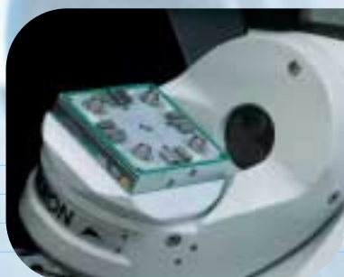
Tavola tilting con dispositivo di bloccaggio palette 3R Dynafix 280 x 280 mm
