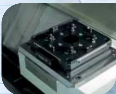
Tavola con dispositivo di bloccaggio integrato del tipo Mecatool GPS 240
