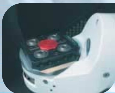
Tavola tilting con dispositivo di bloccaggio palette Erowa UPC 320 x 320 mm
