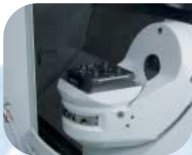
Tavola tilting con dispositivo di bloccaggio palette Meccatool GPS 240, 240 x 240 mm
