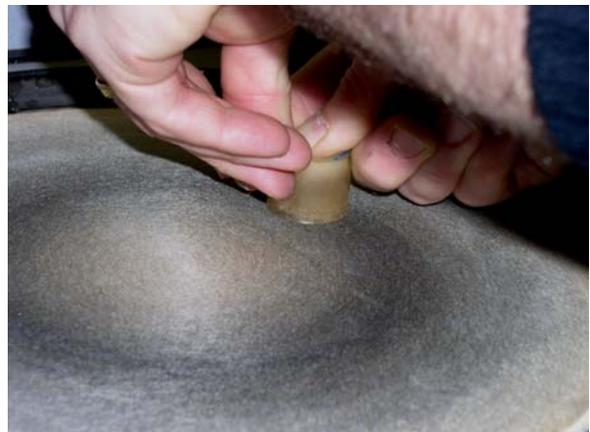
*Operazione di lucidatura con disco in feltro e pasta abrasiva.*
