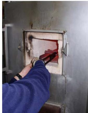
*Estrazione di una provetta per prova di trazione dopo permanenza a  $850^\circ\text{C}$  per circa 1 ora.*
