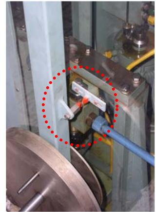
4. **Fissaggio della provetta:** a questo punto si passa al posizionamento vero e proprio della provetta sulle due ganasce come precedentemente mostrato. Assicurarsi che la provetta sia sollecitata a trazione e non a momento flettente.
