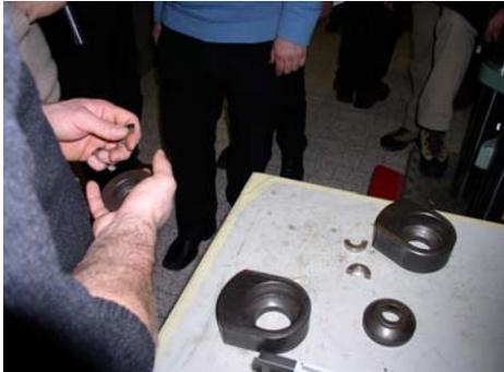
*Supporti per ganasce per provette con teste a spalla*
