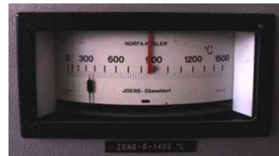
*Termostato con i due indici uno regolabile alla temperatura voluta, uno che dà la temperatura raggiunta.*
