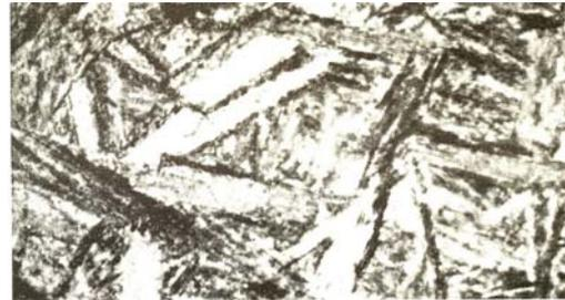
Microstruttura di bainite inferiore (con attacco e 1000x)
