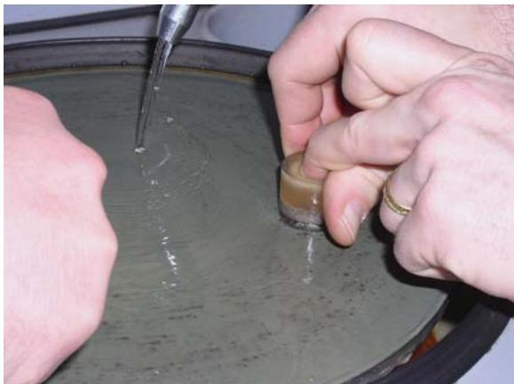
*Operazione di smerigliatura con disco abrasivo lubrificato con acqua.*
