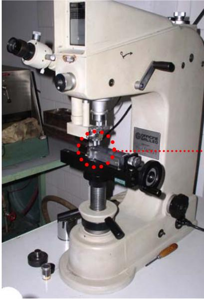
*Durometro Vickers con incudine per prova Jominy inserita sul porta provini.*
