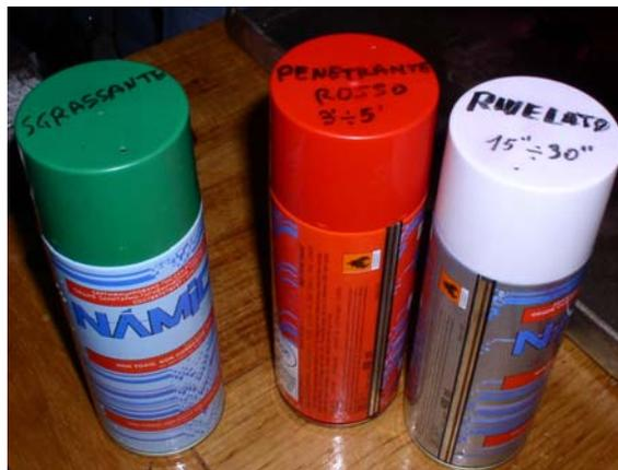
Bombolette spray necessarie per effettuare una prova con liquidi penetranti.
