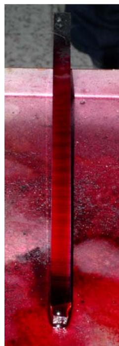
*Provetta ricoperta con liquido penetrante*
