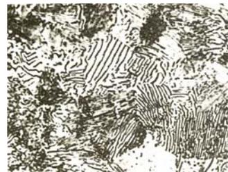
*Struttura prevalente: perlite lamellare.*
