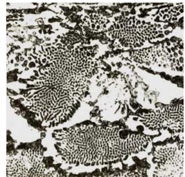
Microstruttura (con attacco e 200x) formata da ledeburite (le zone punteggiate) e cementite (le macchie bianche).
