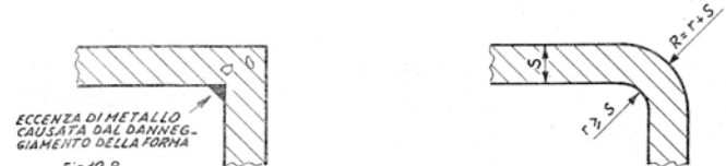
Fig.12.8 FRAGILITÀ DI SPIGOLI E RISUCCHI SI ELIMINANO CON CONVENIENTI RACCORDI
