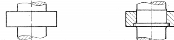
Fig 12.54 EVITARE LA RICALCATURA DEI COLLARI SUGLI ALBERI POICHE' MOLTO COSTOSA. E' PREFERIBILE RIPORTARE I COLLARI MEDIANTE ACCOPPIAMENTI STABILI A CALDO O A FREDDO
