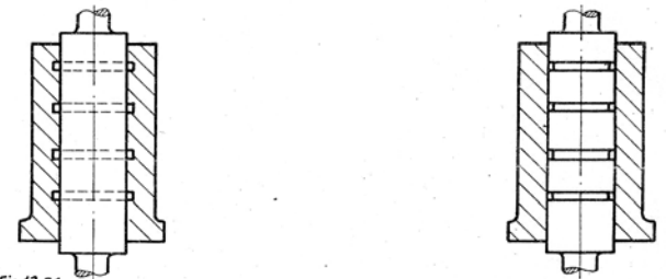
Fig. 13.31 LA GOLA SULL'ALBERO COSTA MENO DI QUELLA ENTRO IL FORO
