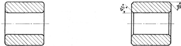
Fig. 13.30 SMUSSI LINEARI ANZICHÉ RACCORDI CIRCOLARI. LO SMUSSO NON DEVE, IN GENERE, SUPERARE 1,2 ÷ 2 mm
