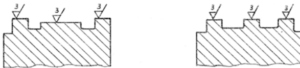
Fig 13.65 ALLINEARE E RIDURRE AL MINIMO LE SUPERFICI DA FRESARE
