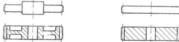
Fig. 13.26 LIMITARE IL NUMERO DELLE OPERAZIONI, SE LE DIMENSIONI DEL PEZZO LO CONSENTONO
