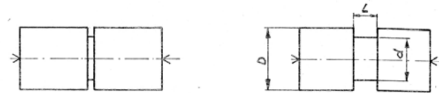
Fig.13.83 NON FARE SCANALATURE TROPPO SOTTILI
