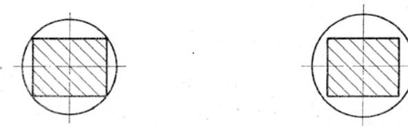
Fig 13.88 GLI ALBERI AVENTI SEZIONI CON MOMENTI D'INERZIA MOLTO DIVERSI SI INFLETTONO IN MODO NON UNIFORME DURANTE LA ROTAZIONE, FACENDO COSÌ DIVENTARE OVALE LA PARTE RETTIFICATA.
